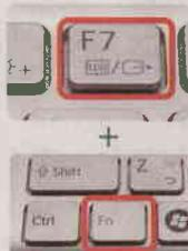
ノートパソコンのディスプレイと外部出力を切り替えるには、専用のキーを使う。通常は「Fn」キーを押しながら使うことが多い
